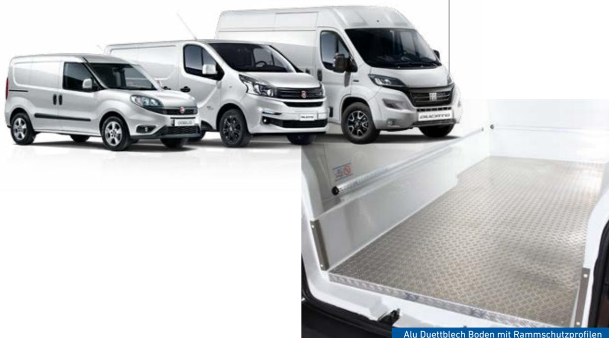
Alu Duettblech Boden mit Rammschutzprofilen
