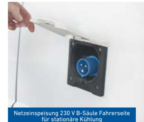
Netzeinspeisung 230 V B-Säule Fahrerseite für stationäre Kühlung
