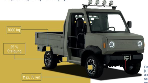
Elektrische Servolenkung (EPS) • Zentrales Informationsdisplay • Dachscheinwerfer • Seilwinde • Elektronische Bremskraftverteilung (EBD)
