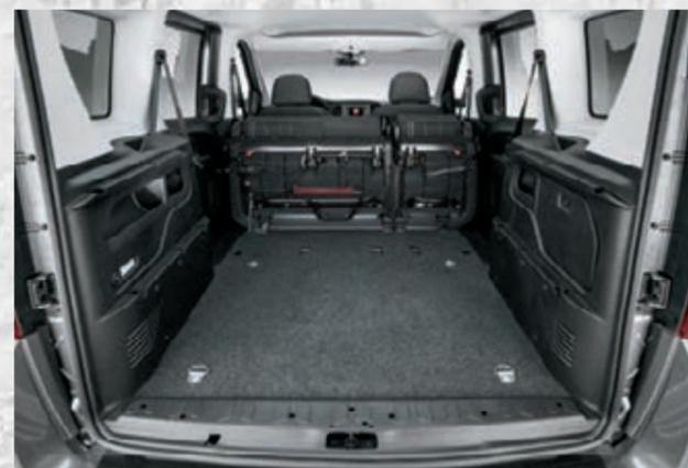
EIN- UND HERUNTERKLAPPBARE RÜCKSITZE. HINTERE SEITENVERKLEIDUNGEN NUR BEI KURZEM RADSTAND VERFÜGBAR
