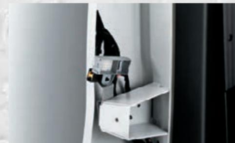
VORVERKABELUNG FÜR AUSSENBAUHERSTELLER MIT STECKDOSE IN DER B-SÄULE (OPT. 081)
