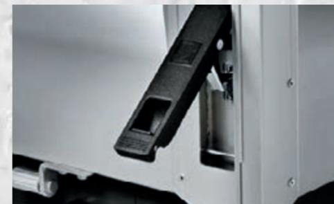
ENTRIEGELUNGSHEBEL DER KLAPPBAREN PRITSCHENWÄNDE
