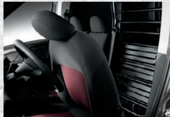
Trenngitter geteilt drehbar, nur für 2-Sitzerkonfiguration verfügbar
