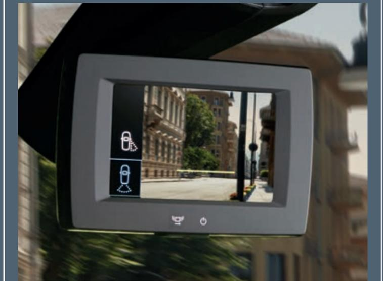
Der Magic Mirror ist eine innovative Ausstattung, die von 2 Kameras aufgenommene Bilder auf einem digitalen 5"-Rückspiegel anzeigt. Er bietet drei verschiedene Ansichten, um Ihnen das Rangieren zu erleichtern. Darüber hinaus sorgt eine ganze Reihe von aktiven und passiven Fahrerassistenzsystemen für eine sichere Fahrt und unterstützt Sie beim Fahren und Manövrieren.
