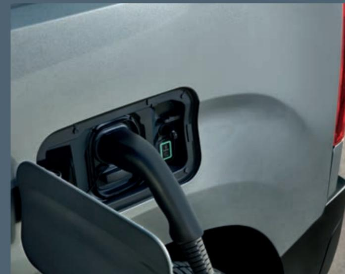
Der neue E-Doblò vervollständigt neben den Diesel- und Benzinversionen das Elektroangebot von Fiat Professional. Sein 100-kW-starker Elektromotor und die 50-kWh-Batterie ermöglichen effizientes, sanftes und reaktionsschnelles Fahren mit einer maximalen Reichweite von bis zu 280 km\* und einer Höchstgeschwindigkeit von 130 km/h. Bis zu 80 % Aufladung der Batterie in 30 Minuten mit der DC-Schnellladefunktion. Er wurde entwickelt, um jeden Tag zuverlässig seine Arbeit zu verrichten.
