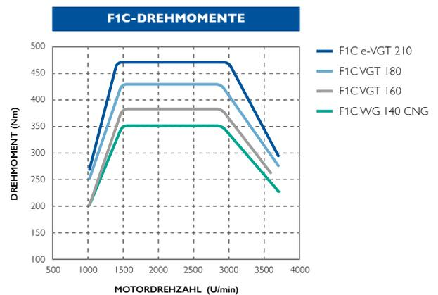
e-VGT: elektronisch gesteuerte variable Turbinengeometrie; VGT: variable Turbinengeometrie; WG: WasteGate; CNG: Compressed Natural Gas
