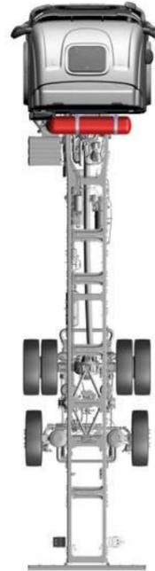
CNG-Tanks hinter dem Fahrerhaus, erhältlich in Kombination mit:
