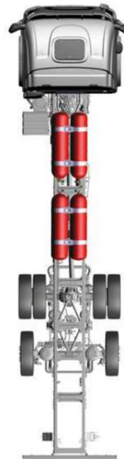
CNG-Tanks auf dem Fahrgestell, erhältlich in Kombination mit:
