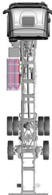
CNG-Tanks auf der linken Seite, erhältlich in Kombination mit CNG-Tanks auf der rechten Seite.
