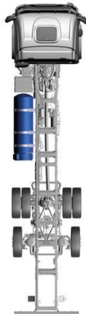
LNG-Tank auf der linken Seite, erhältlich in Kombination mit LNG-Tank auf der rechten Seite.
